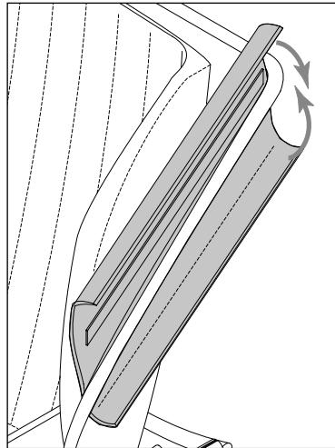
Прикрепите накладки с помощью крючка и петли вокруг боковых толкателей прогулочной коляски (более широкая сторона накладки обращена вниз) и закройте крючок и петлю.
